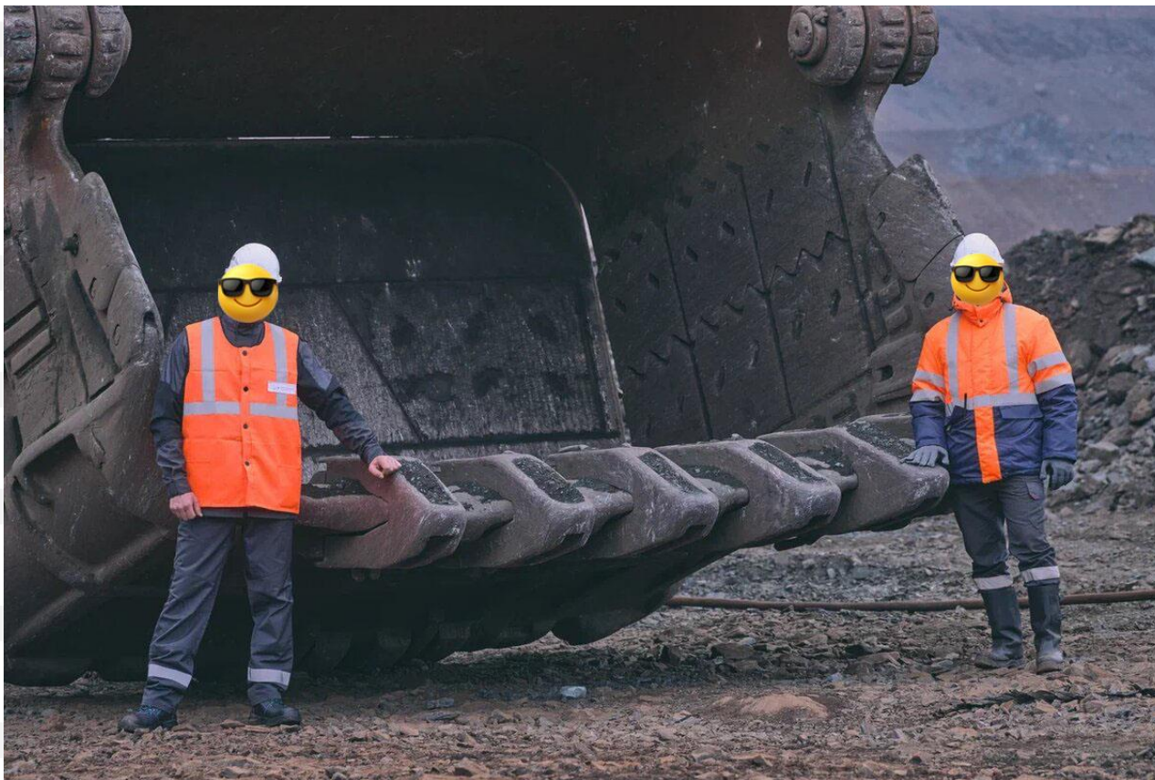
Фото 6 – Переоборудованный ковш 25м3 экскаватора WK-35
