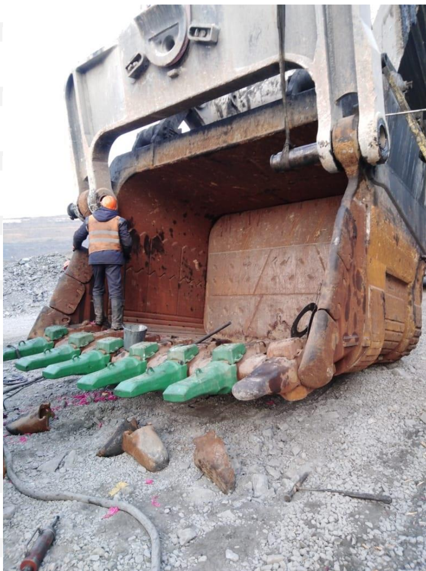
Фото 2 – Замена коронок и техническое обслуживание ковша на экскаваторе WK-35
