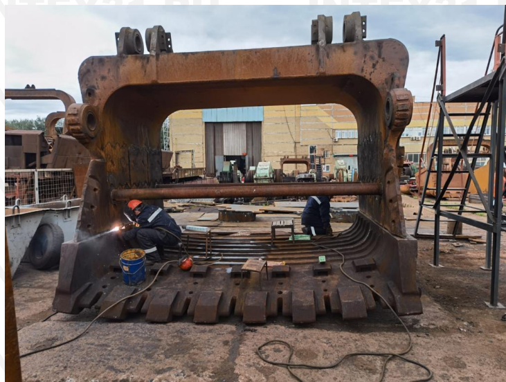
Фото 4 – Замена передней стенки корпуса ковша экскаватора WK-35
